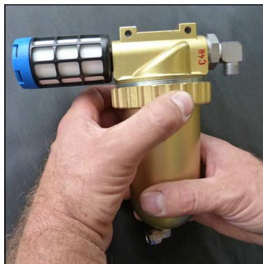
Fig. 1 - Loosen ring nut
