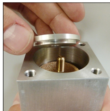
Abb. 5 - Filterscheibe und Unterlegscheibe aufsetzen
