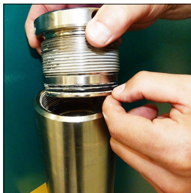
Abb. 2 - O-Ring und Stützring wechseln
