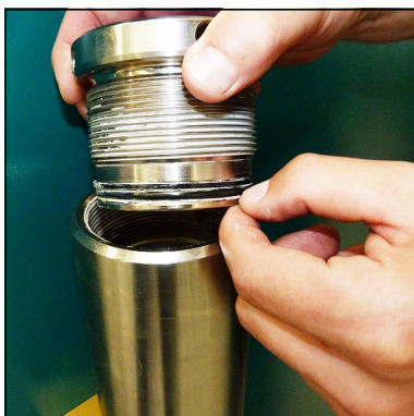
Abb. 2 - O-Ring und Stützring wechseln
