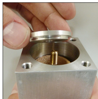
Abb. 5 - Filterscheibe und Unterlegscheibe aufsetzen
