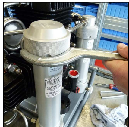
Abb. 1 - Filtergehäusedeckel mit Filterschlüssel
