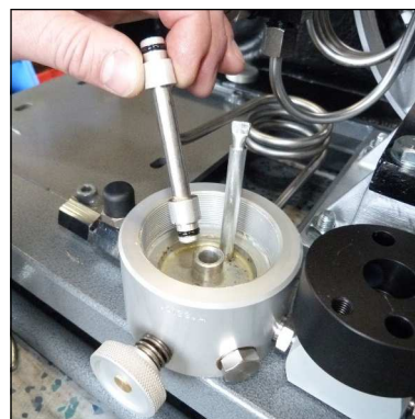
Abb. 5 - Verbindungsstutzen abziehen und O-Ringe wechseln
