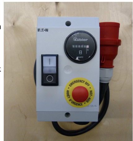
Schaltkasten mit Betriebsstundenzähler
