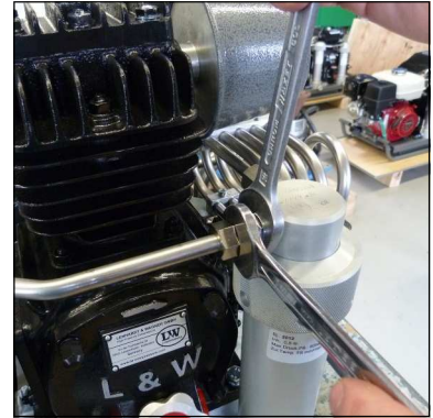
Abb. 1 - Rohrleitungsverschraubung Wasserabscheider lösen
