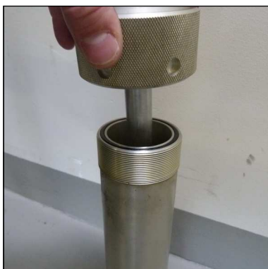
Abb. 4 - Befestigungsring entfernen und O-Ring wechseln
