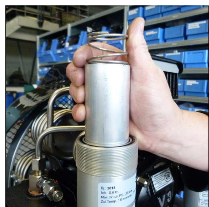
Abb. 3 - Filterpatrone und Feder
