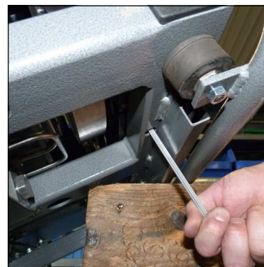
Abb. 3 - Befestigungsschrauben unten lösen
