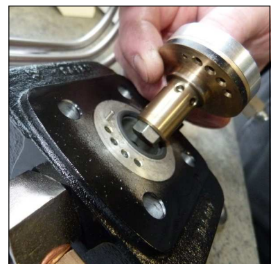
Abb. 4 - Auf Positionierung von Ventil achten (Zentrierstift)
