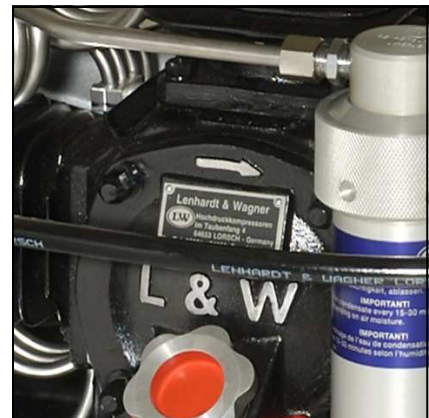
Drehrichtungspfeil auf dem Kompressorblock
