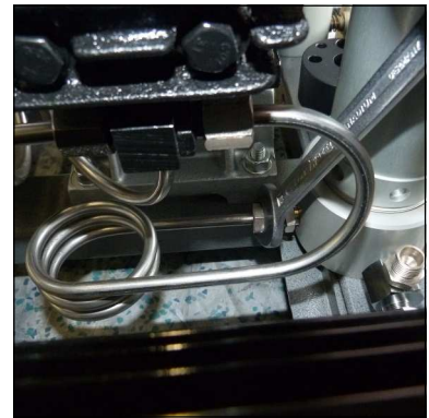
Abb. 2 - Rohrleitungsverschraubung Filtergehäuse lösen
