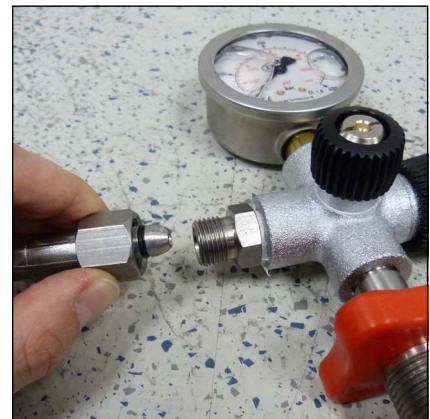
Abb. 2 - O-Ring am Füllschlauch
