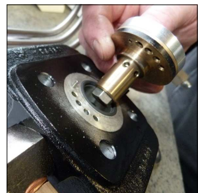
Abb. 5 - Auf Positionierung von Ventil achten (Zentrierstift)
