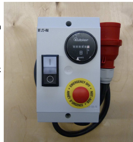
Schaltkasten mit Betriebsstundenzähler
