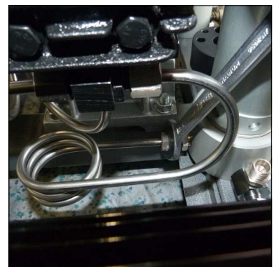
Abb. 2 - Rohrleitungsverschraubung Filtergehäuse lösen
