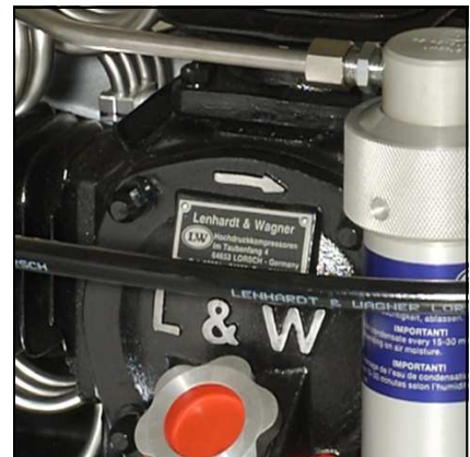
Drehrichtungspfeil auf dem Kompressorblock
