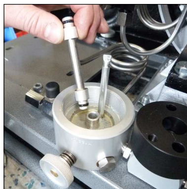
Abb. 5 - Verbindungsstutzen abziehen und O-Ringe wechseln
