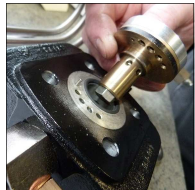
Abb. 4 - Auf Positionierung von Ventil achten (Zentrierstift)
