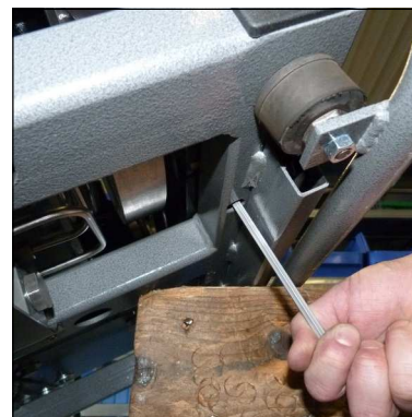
Abb. 3 - Befestigungsschrauben unten lösen
