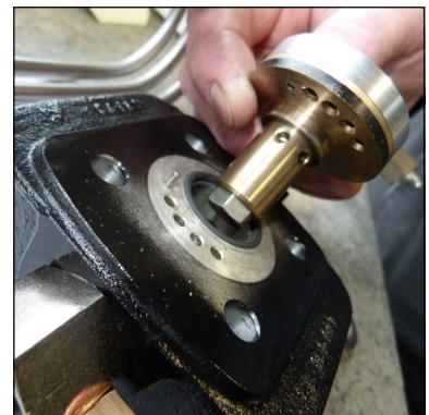
Abb. 4 - Auf Positionierung von Ventil achten (Zentrierstift)
