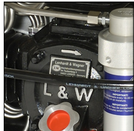
Drehrichtungspfeil auf dem Kompressorblock
