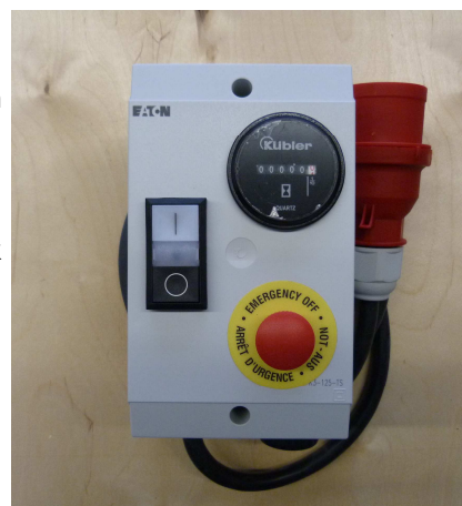
Schaltkasten mit Betriebsstundenzähler
