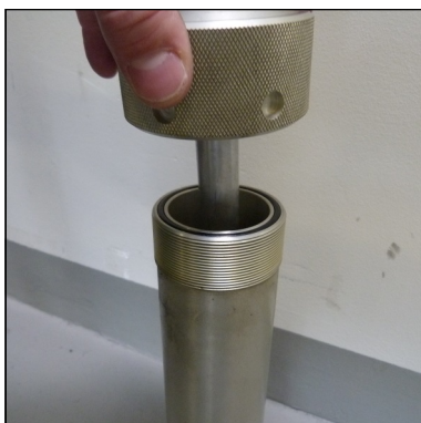
Abb. 4 - Befestigungsring entfernen und O-Ring wechseln
