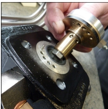
Abb. 1 - Auf Positionierung von Ventil achten (Zentrierstift)
