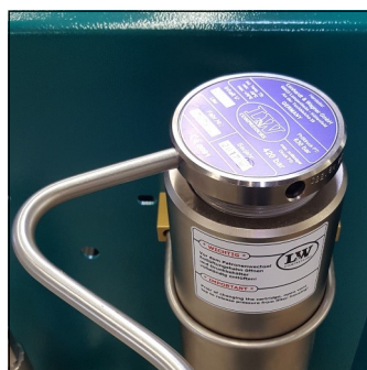
Abb. 2 - Abschrauben des Filtergehäuse-Deckels
