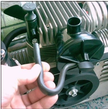
Abb. 1 - Entlüftungsschlauch am Öleinfüllstutzen abziehen
