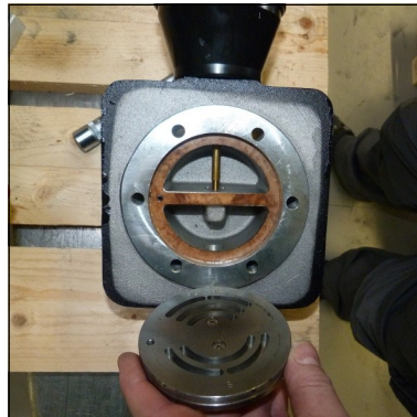
Abb. 2 - Saug- und Druckventil entnehmen
