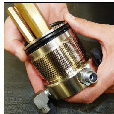
Abb. 4 - O-Ring und Stützring wechseln
