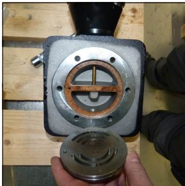
Abb. 2 - Auf korrekte Platzierung der oberen Dichtung achten!
