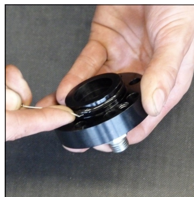
Abb. 4 - O-Ring wechseln (Deckel Kondensat-Stopp-Ventil)
