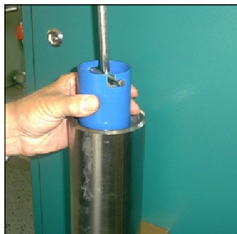
Abb. 4 - Filterpatrone aus dem Gehäuse entnehmen
