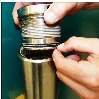
Abb. 2 - O-Ring und Stützring wechseln
