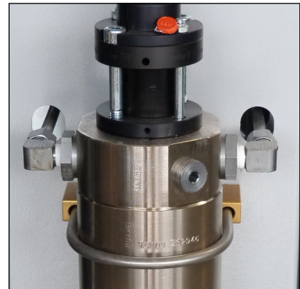
Abb. 1 - Rohrleitungsverraubungen und Muttern lösen
