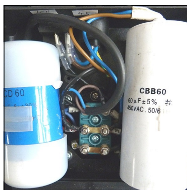
Fig. 2 - Connections LW 100 E1
