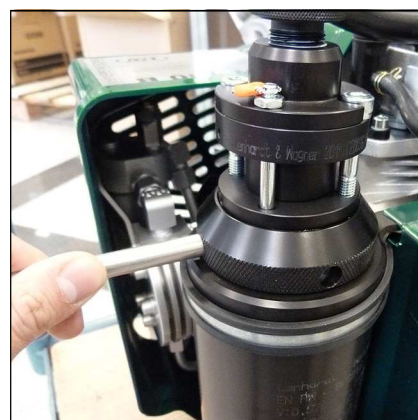
Abb. 1 - Filtergehäusedeckel mit Filterschlüssel öffnen
