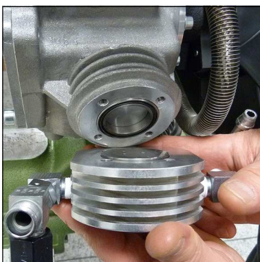
Abb. 3 - Ventilkopf mit Saug- und Druckventil entnehmen
