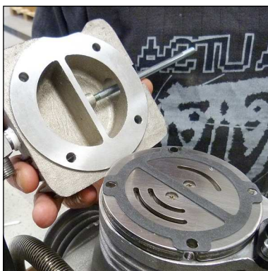
Abb. 7 - Ein- und Auslasskanäle müssen genau zentriert sein
