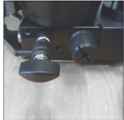
Endwässerungshahn und Druckhalte-/Rückschlagventil
