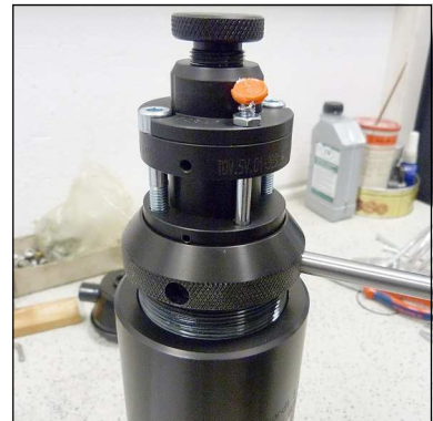
Abb. 1 - Filterdeckel abdrehen/ eindrehen
