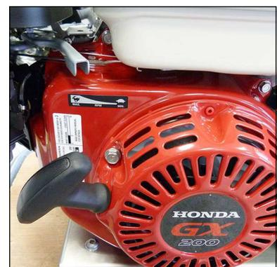
Abb. 2 - Drehzahl Regulierung und Handstart
