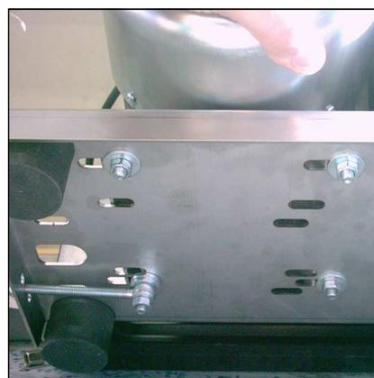
Abb. 1 - Befestigungsmuttern Antriebsmotor
