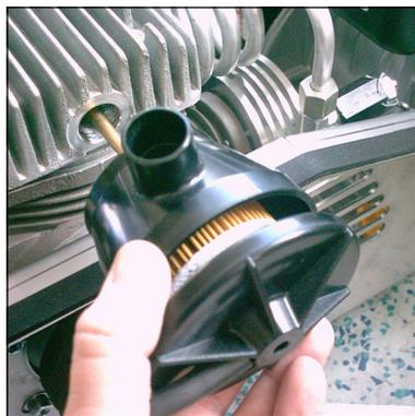
Abb. 2 - Filtergehäuse vorsichtig herausziehen
