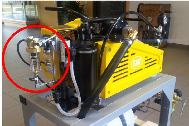
Das Absperrventil an dem Ölabscheider muss während des Betriebs des Kompressors geschlossen sein!
