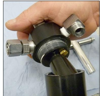
Abb. 3 - Kopf ausdrehen und entnehmen
