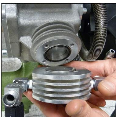
Abb. 3 - Ventilkopf mit Saug- und Druckventil entnehmen
