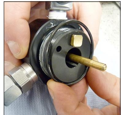
Abb. 6 - O-Ring wechseln
