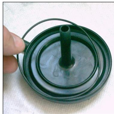
Abb. 3 - O-Ring in Gehäusedeckel einlegen
