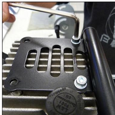
Abb. 3 - Ventilkopfschrauben lösen
