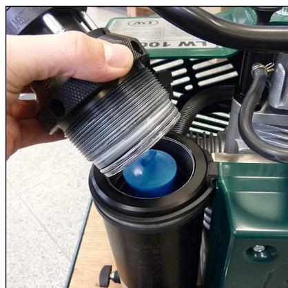
Abb. 2 - Filtergehäusedeckel entnehmen
