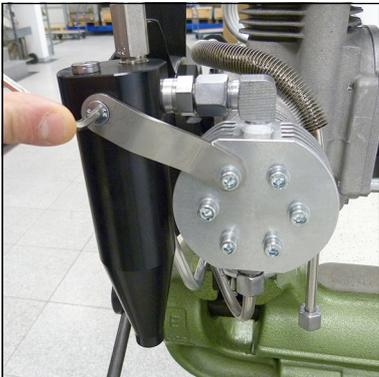
Abb. 1 - Befestigungsschraube lösen
