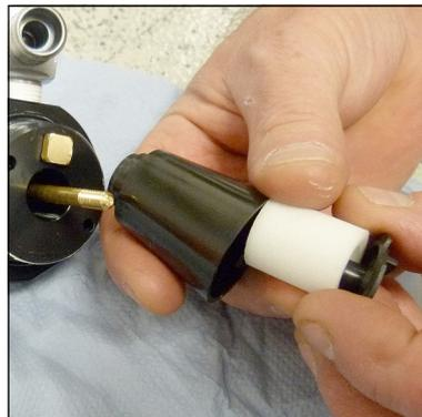
Abb. 5 - Sinterfilter wechseln
