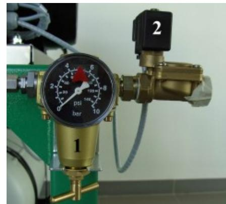
Das Magnetventil am Eingang des Kompressorsystems blockiert die Zufuhr von Stickstoff nach Abschaltung des Kompressors. Nur während des Betriebs wird das Magnetventil geöffnet und der Stickstoff kann in den Puffertank fließen.
