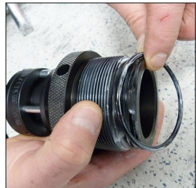
Abb. 2 - O-Ring wechseln
