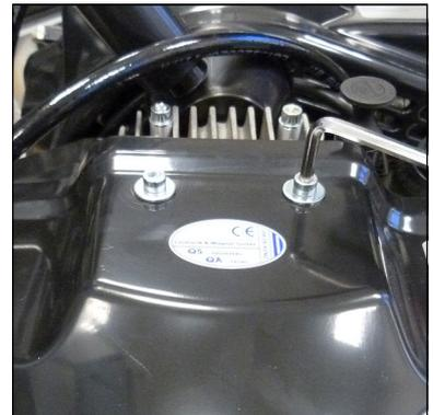
Abb. 1 - Befestigungsschrauben der Ventilator-Schutzabdeckung lösen
