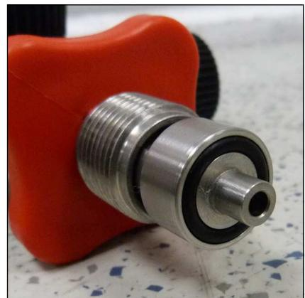
Abb. 1 - O-Ring am Füllventil
