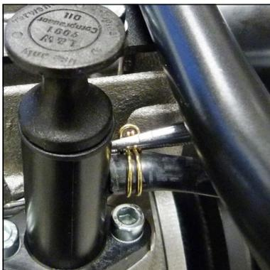
Abb. 2 - Klemmring entfernen
