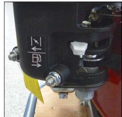
Abb. 1 - Kraftstoff-Sperrhahn
