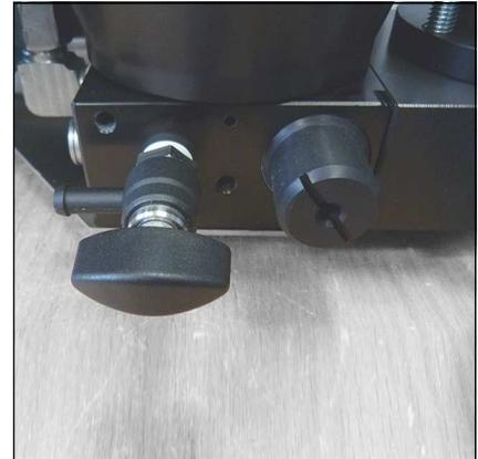
Endwässerungshahn und Druckhalte-/Rückschlagventil
