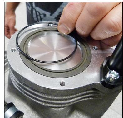
Abb. 5 - O-Ring wechseln
