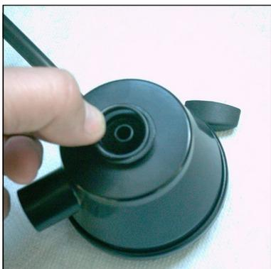
Abb. 4 - O-Ring in Zentrierbund einlegen
