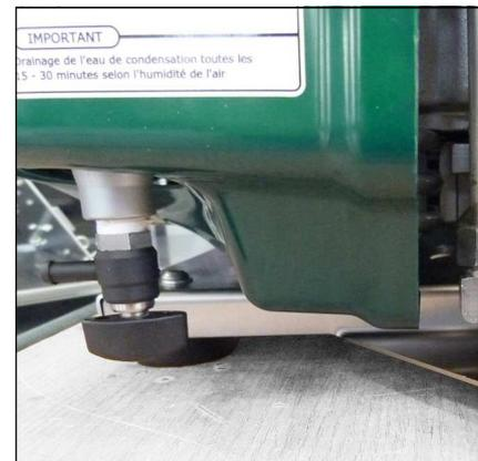
Abb. 1 - Kondensatablasshahn 2.Stufe
