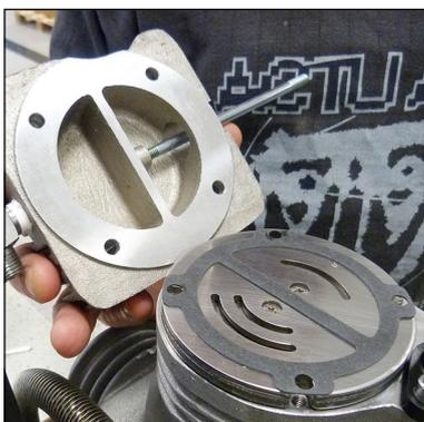
Abb. 7 - Ein- und Auslasskanäle müssen genau zentriert sein
