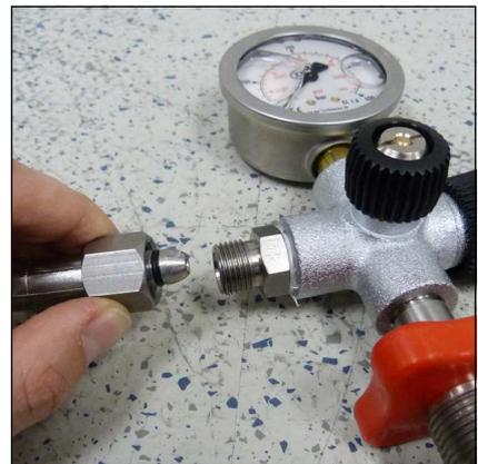
Abb. 2 - O-Ring am Füllschlauch
