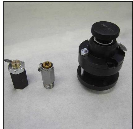
Sicherheitsventile 1. Stufe / 2. Stufe / 3. Stufe
