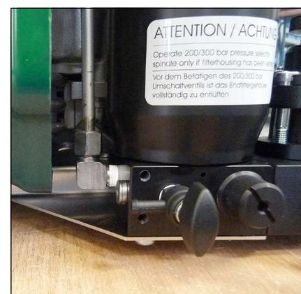
Abb. 2 - Kondensatablasshahn 3.Stufe
