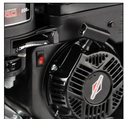
Abb. 2 - Drehzahl Regulierung und Handstart
