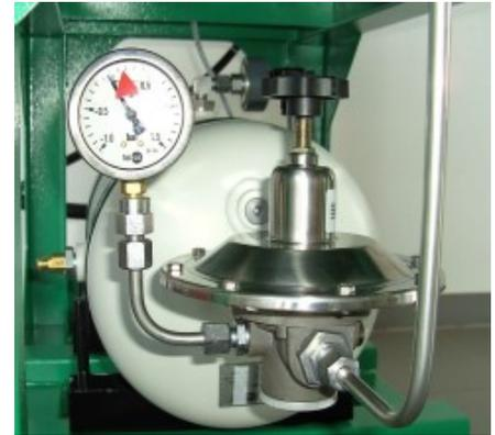
Der Präzisionsdruckminderer muss auf +0,15 bar eingestellt sein. (Werkseinstellung)
