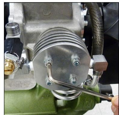
Abb. 2 - Ventilkopfschrauben lösen
