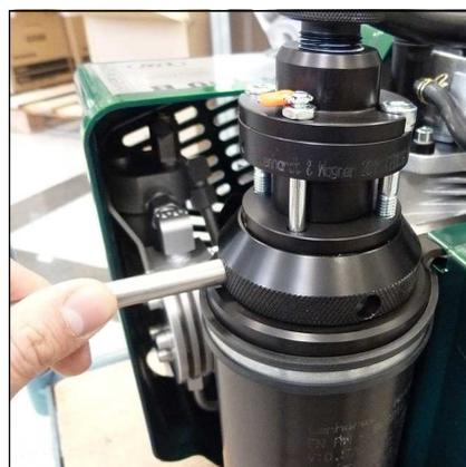
Abb. 1 - Filtergehäusedeckel mit Filterschlüssel öffnen
