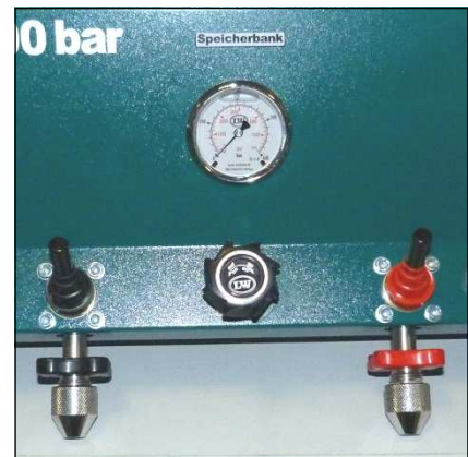
Abb. 1 - Drehventil und Manometer
