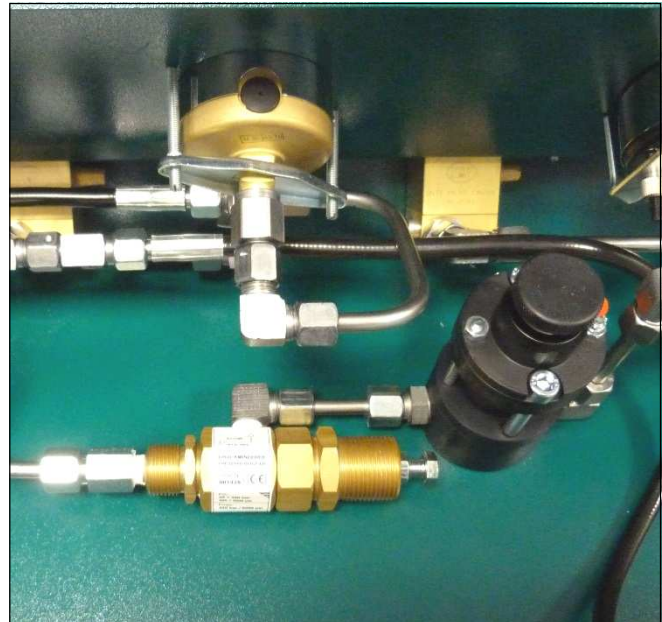
Druckminderer (li.) & Sicherheitsventil (re.)
